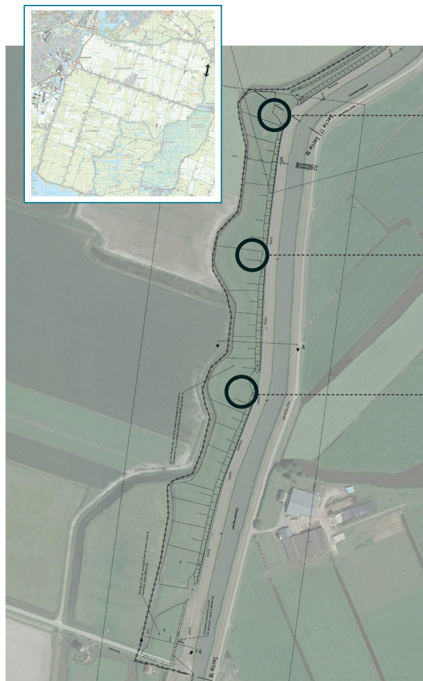
Kadeversterking volgens projectplan met daarop de molenplaatsen aangegeven
