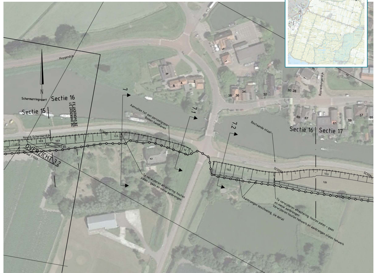
Kadeversterking volgens project
